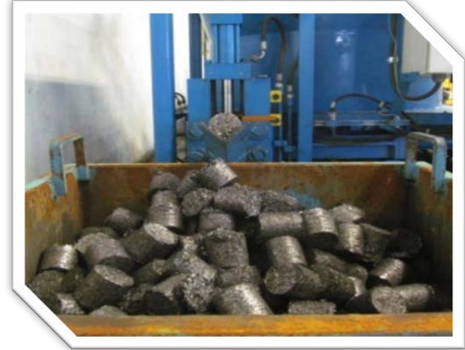
Resim-2: Presleme Makinasından Çıkan Talaşlar
